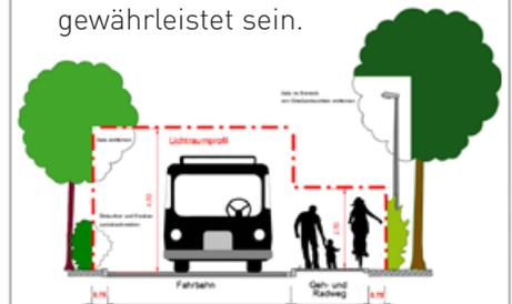
Lichtraum: beidseitig 0,75 Meter breiter als der Verkehrsraum, Höhe 4,5 Meter; Lichtraumhöhe für Fuß- gänger- und Radverkehr 2,5 Meter.
